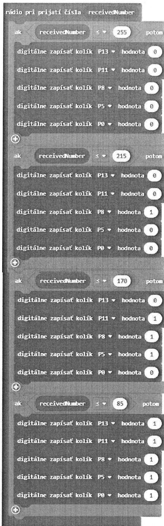
Obr. 14 Druhá časť programu vnútorného micro:bitu z vnútorného osvetlenia (foto Martikáňová V., 2022)
