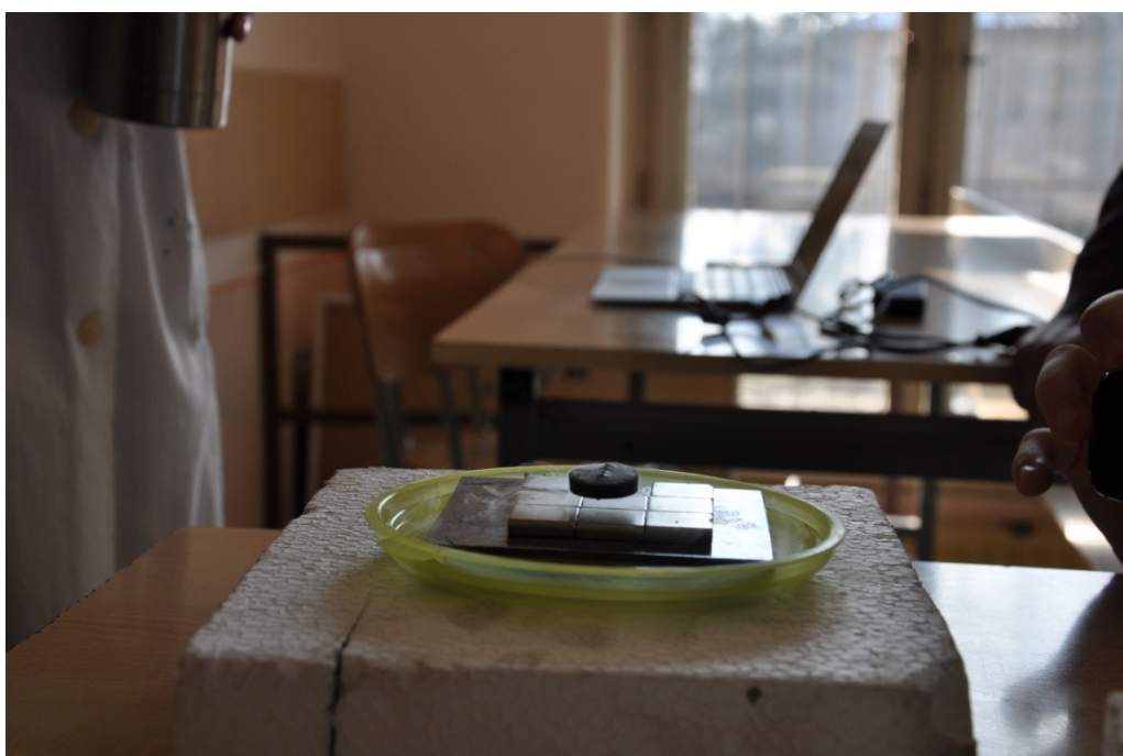
Levitácia supravodiča v magnetickom poli neodýmiových magnetov
